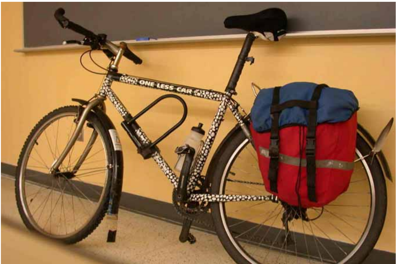
Photo : Un vélo prêt pour son quatrième hiver. On peut voir le garde-boue avant rallongé, les poignées ou «cornes» recouvertes de mousse et le cadenas, serrure vers le bas.
